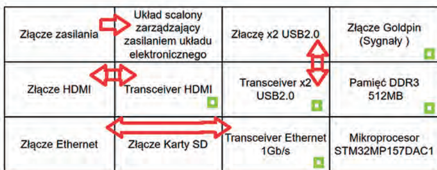
Rys. 5. Schemat blokowy układu elektronicznego projektu PCB przedstawionego na rys. 4
