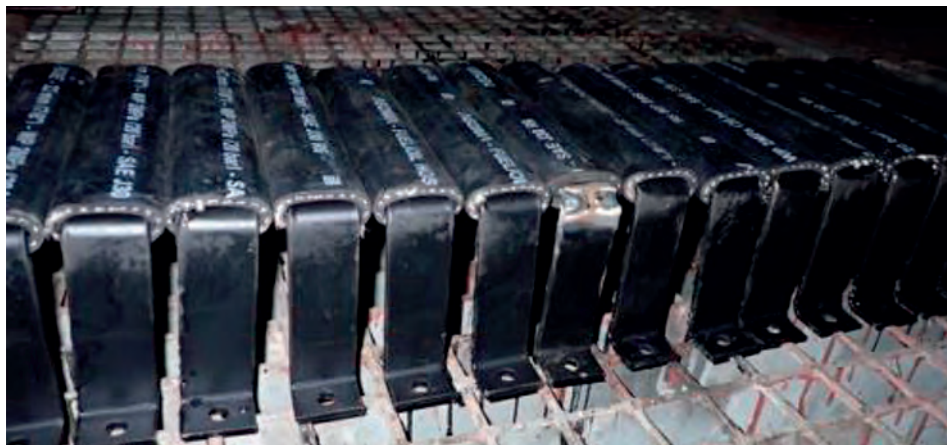
Rys. 4. Ogniwa gąsienicy po montażu gumowych nakładek z węża hydraulicznego i malowaniu
