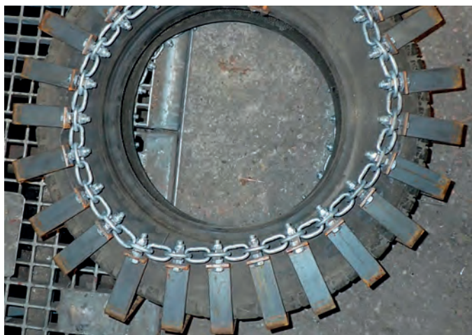
Rys. 6. Gąsienica przed modyfikacją – brak gumowych nakładek, łańcuch łączący na zewnątrz ogniów – w efekcie znaczny kąt rozchylenia na kole, co powoduje wzmożony opór ruchu, po „zejściu” z koła, przechodzą w dolny poziomy odcinek, więc gąsienica musi dokonać znacznych odkształceń gruntu
