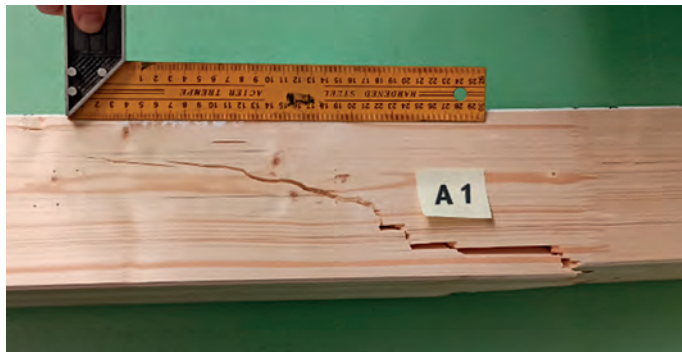
Rys. 28. Obraz zniszczeń rozpoczynający się od mikrowczepu, belka serii A nr 1
