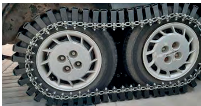
Rys. 7. Zmodyfikowana gąsienica po zamontowaniu. Gumowe nakładki, niepowodujące uszkodzenia podłoża, oraz przemieszczony o ok. 30 mm na zewnątrz łańcuch spinający, a w efekcie znacznie zmniejszony kąt rozchylenia ogniów na kole pojazdu
