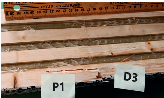
Rys. 29. Obraz zniszczeń rozpoczynający się od mikrowczepu, belka serii D nr 3
