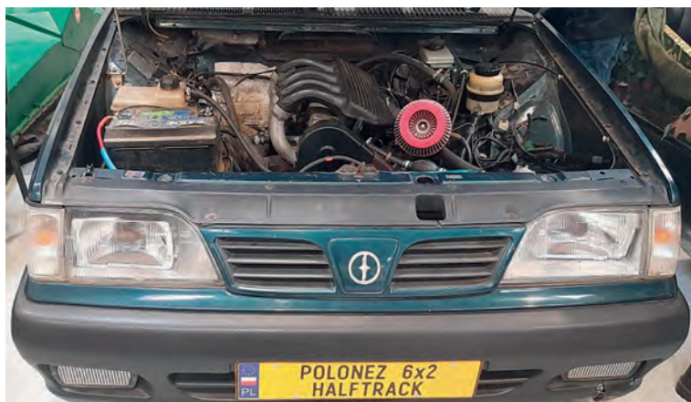
Rys. 2. Komora silnika po zamontowaniu silnika wysokoprężnego
