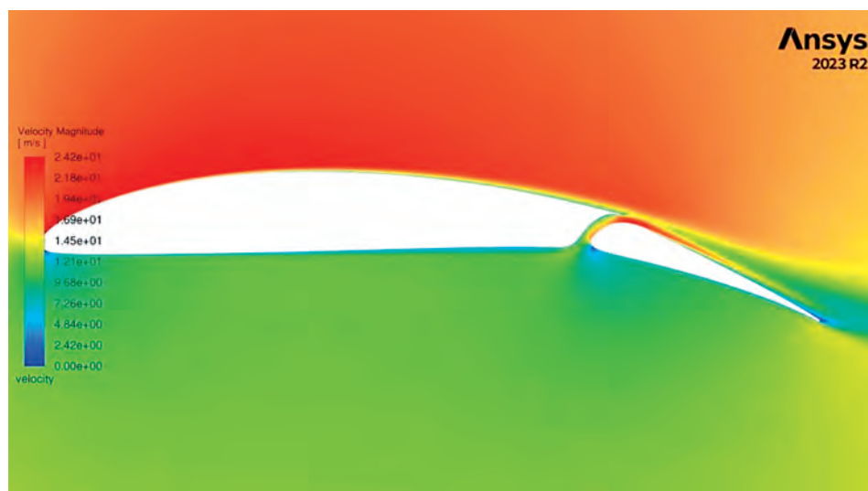
Rys. 5. Przyspieszenie przepływu w klapie szczelinowej
