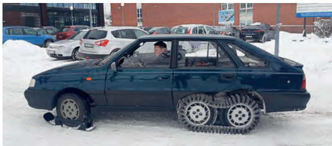
Rys. 1. „Polonez 6 × 2 Halftrack” przed modyfikacją gaśienic
