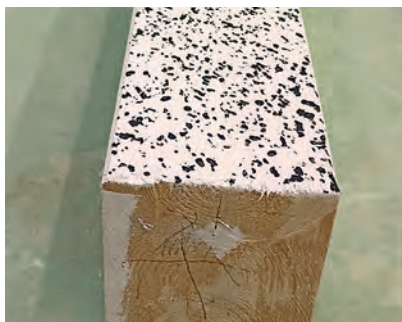
Rys. 8. Belka przygotowana do badania systemem ARAMIS z naniesionym wzorem
