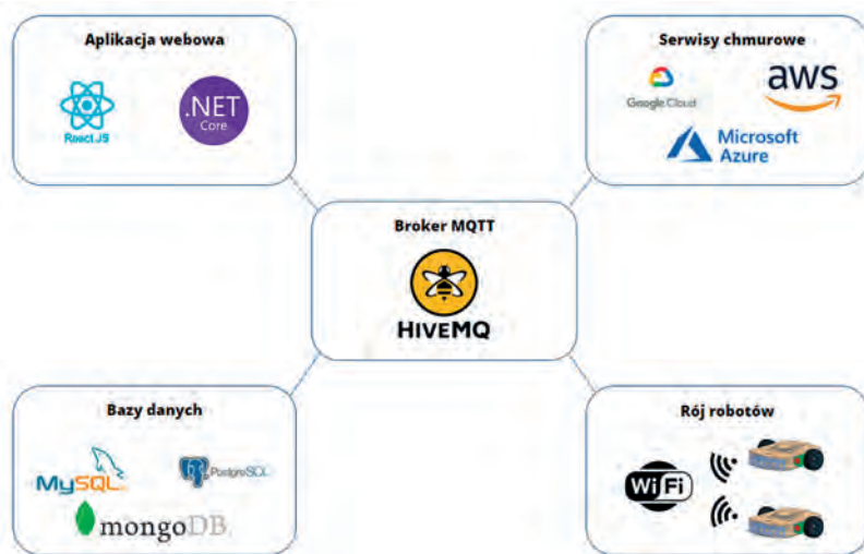
Rys. 6. Model komunikacji w protokole MQTT
